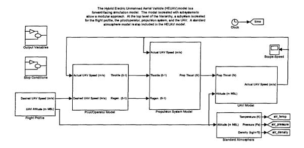
Figure 4-1: HEUAV Simulink Model
